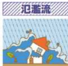
氾濫した洪水の流速が早く、木造家屋が倒壊する恐れのある区域
